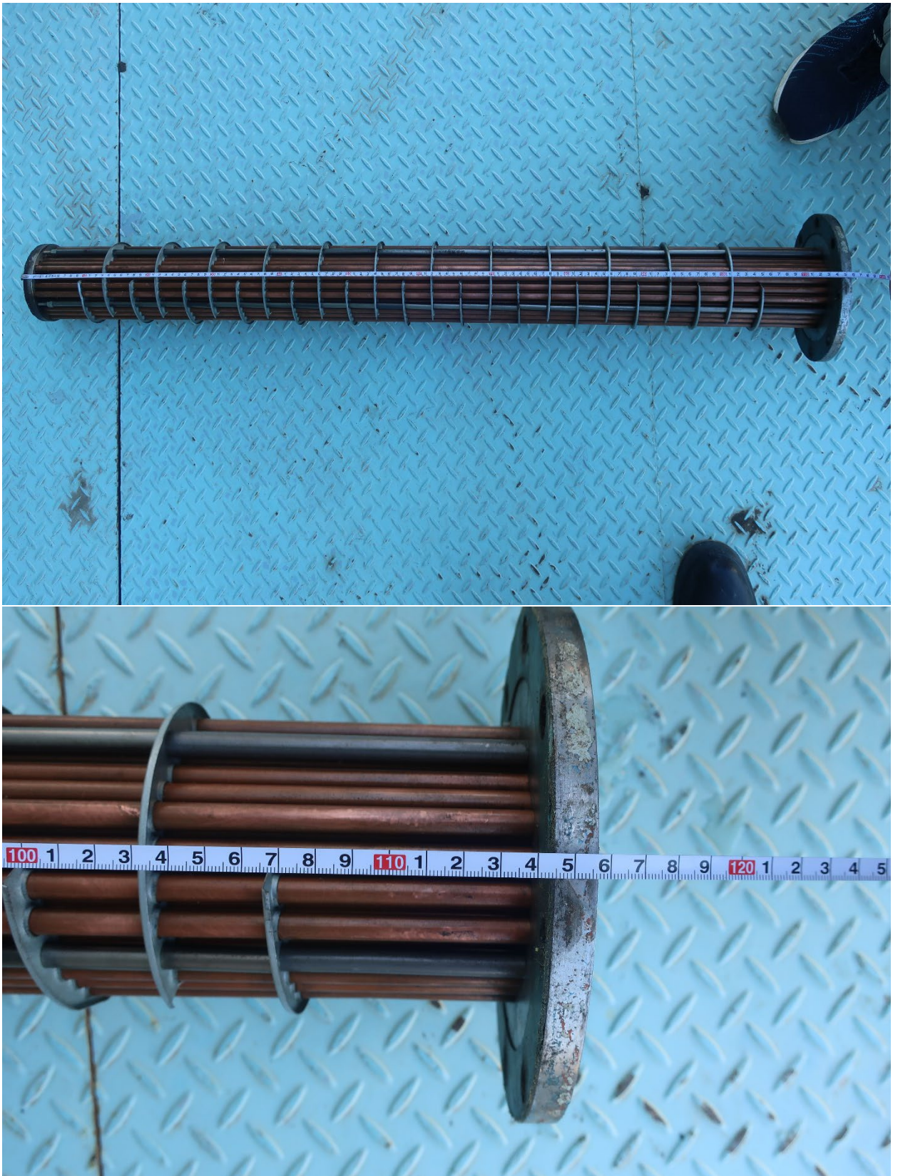
Рис. 1. Длина трубного пучка охладителя масла E-3414: L = 115,6 мм.
