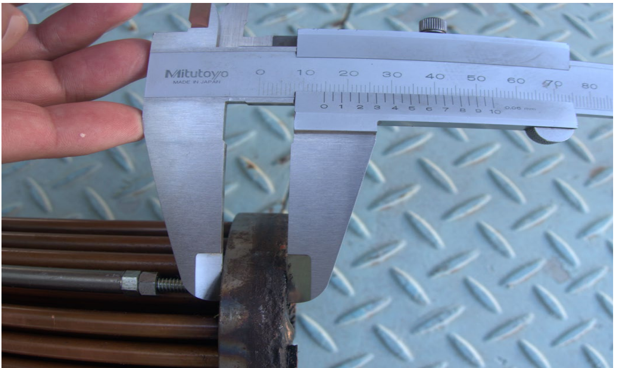
Рис. 4. Толщина фланца со стороны конечного изгиба потока для трубного пучка масляного охладителя E-3414: T = 15 мм. (Задняя сторона теплообменника).
