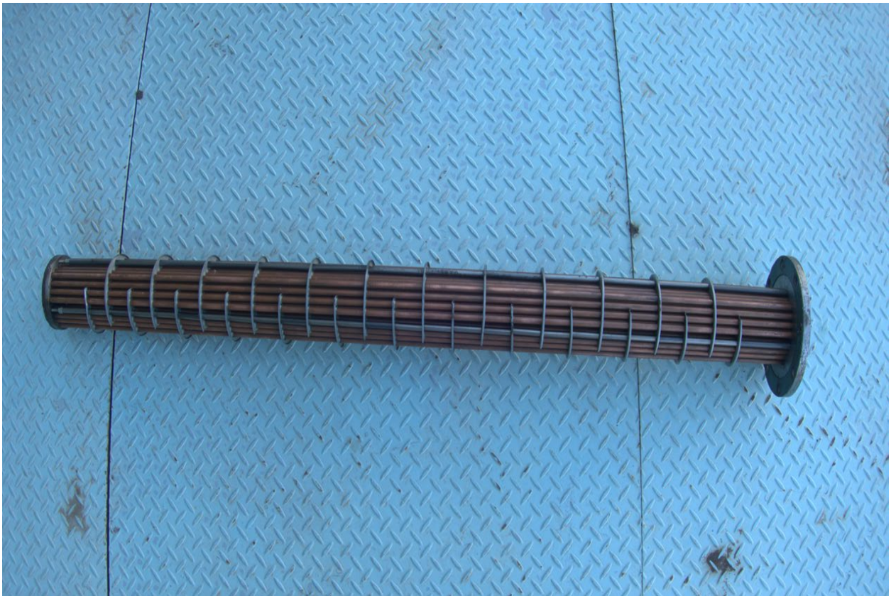
Рис. 7. количество перегородок масляного охладителя составляет 25 штуки.
